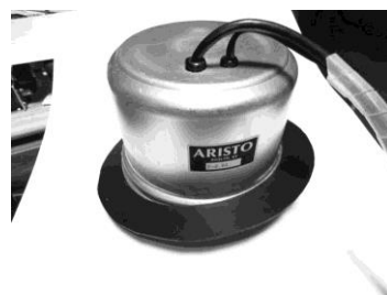
写真⑩ 耐熱ゴムの自家製シール
