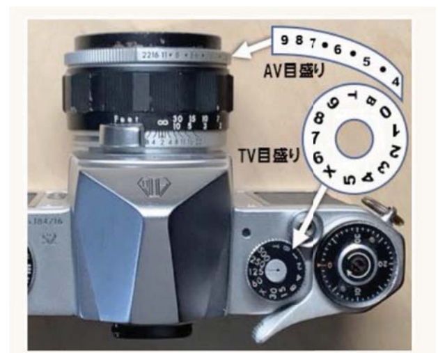
図3 絞り環にAV目盛りを シャッターダイヤルにTV目盛りを貼る
